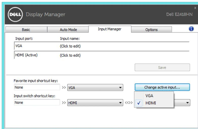
**CATATAN:** DMM berkomunikasi dengan monitor bahkan saat monitor menampilkan video dari komputer lain. Anda dapat menginstal DDM di PC yang sering digunakan dan mengatur pengalihan input dari PC tersebut. Anda juga dapat menginstal DDM di PC lain yang tersambung ke monitor.
